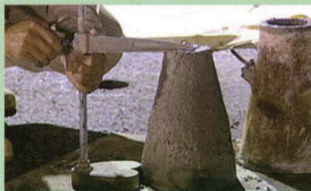
大切な材料管理、スランプ試験
